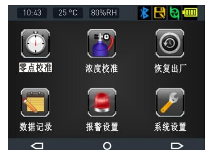
选择要校准的通道，按“OK”键进行零点校准，校准成功以后显示：“校准成功”字样，如右图及下图：
