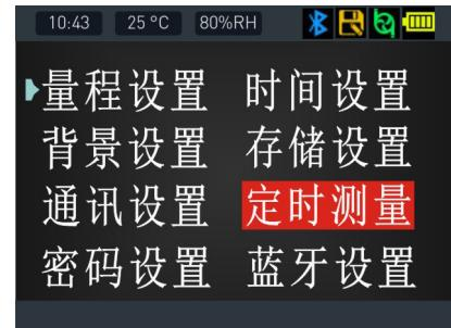
默认的测量时间是0秒，如果不修改这个数值，此功能不起作用，当修改为一定的数值，此功能开始起作用，若要使用定时测量的功能。一般情况下需要把数值修改为30到60秒，按一下泵的开关“PUMP”键开始测量，达到设定的时间就停止测量。
