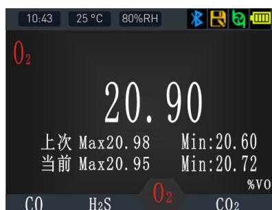
此时在模式二界面再按OK键可切换到气体显示曲线图(模式三)，(图与实际产品有偏差，建议图参考实物)，如右图：
