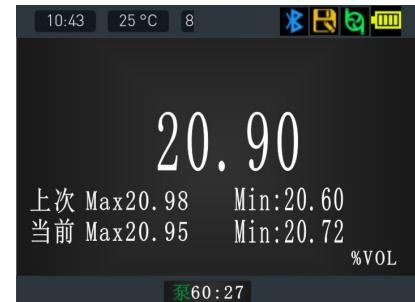
定时测量的界面：显示屏底部显示设定的时间和剩余时间。
